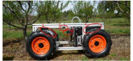
Fig. 2. R2A2: 1) Reservatório de herbicida 2) Sistema de Visão computacional. 3) Braço robótico cartesiano com pulverizador. 4) Sistema de controlo.
