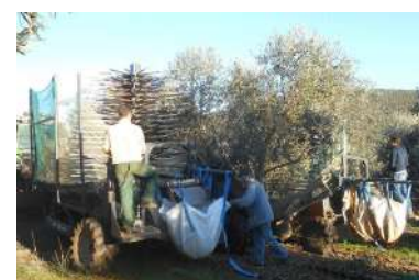
Colheita em contínuo com Máquina Colheita Contínua de Azeitona (MCCA)
