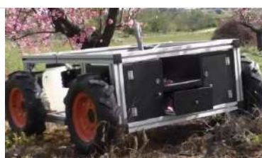
Fig. 2. Rover Robótico multitarefa para Atividades Agrícolas (R2A2).
