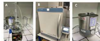
Figura 2 – Metodologias de extração testadas, sendo que (A) Maceração com temperatura e agitação, (B) Extração assistida por micro-ondas e (C) Extração assistida por ultrassons.
