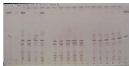
Figura 2 – Monitorização por TLC da capacidade de transformação em grande escala do ácido abiético por duas estirpes de isolados fúngicos.
