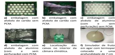
Figura 4 – Ensaios experimentais de análise do comportamento térmico de embalagem com diferentes tipos de alvéolos.
